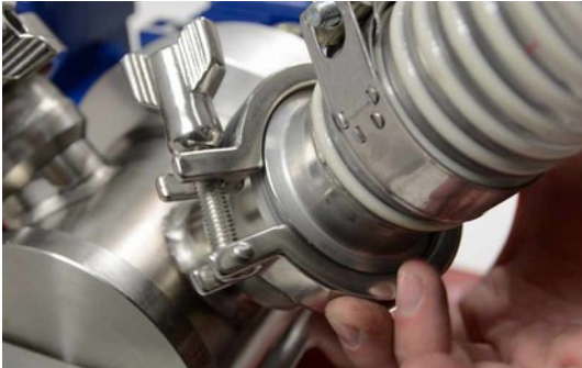
Прикрепить шланг к ротору с помощью штативной площадки
