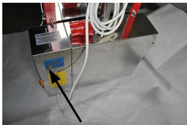
Рис. 7 Экран температуры, который показывает актуальную температуру воды.
