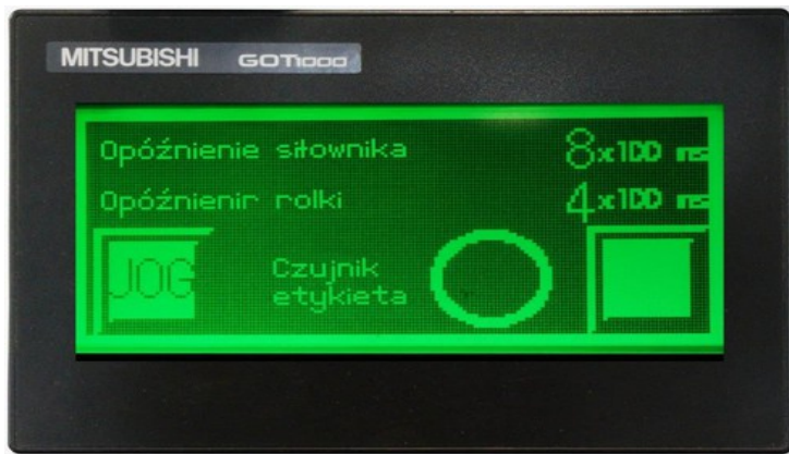
Фото 11. Настройка задержки рулона и сервомотора
