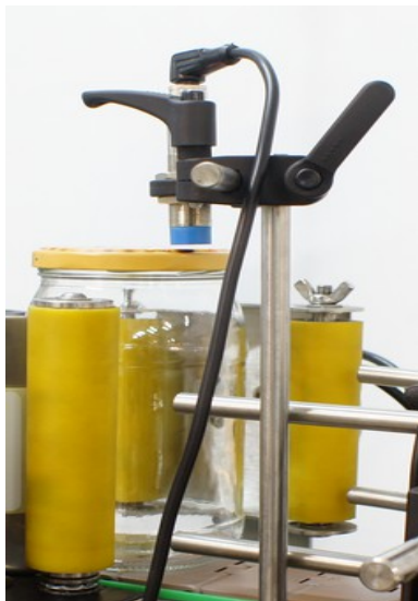
Фото 4. Настройка индукционного датчика
