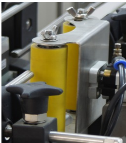
Фото 5. Сервомотор с прижимающими валиками
