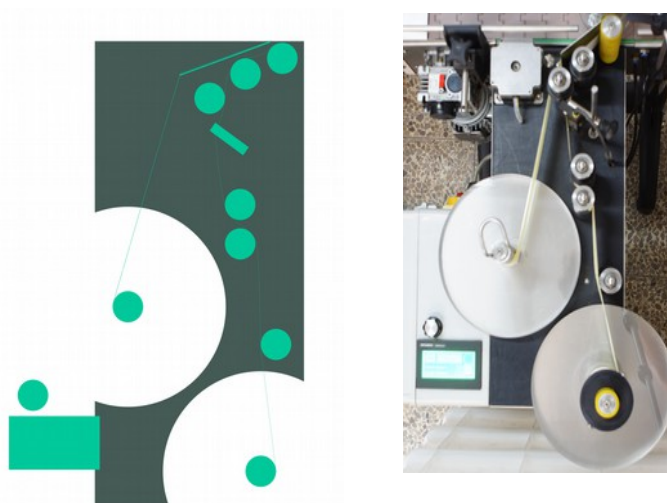
Рис.1. Схема размещения ленты с этикетками
