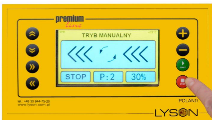
Фото 4 Кнопка „СТОП” остановка вращения корзины.
