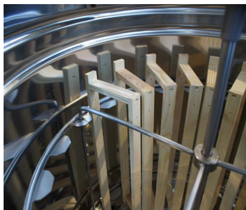
Фото 2. Правильная укладка рамок в корзине радиальной.
