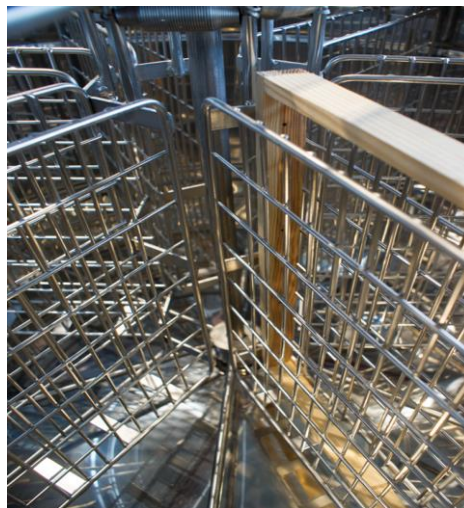
Фото 1. Правильная укладка рамок в корзине кассетной
