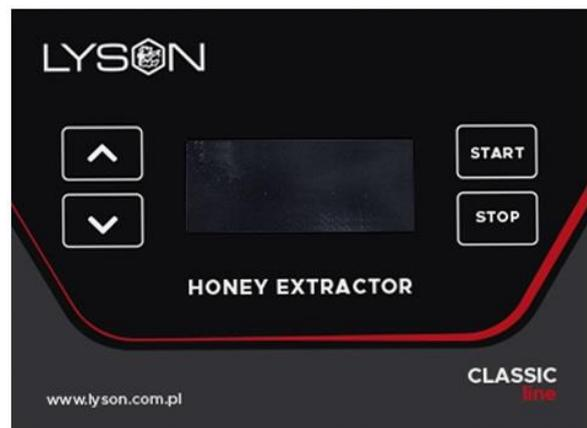
С помощью кнопок ВВЕРХ / ВНИЗ необходимо выбрать нужный режим работы медогонки и подтвердить выбор с помощью кнопки СТАРТ, которая также служит для включения меню редактирования выбранного параметра. Кнопка СТОП прекращает работу медогонки и служит для выхода из меню редактирования настроек блока управления. Пользователь может выбрать следующие программы/режимы: ручной откачки вправо, ручной откачки влево, 10 автоматических программ и
