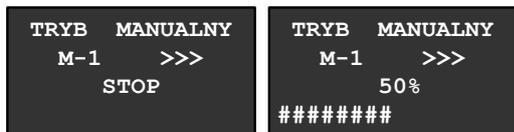
Строка в нижней части дисплея дополнительно указывает величину установленной скорости (16 светящихся полей означают 100% возможной скорости откочки).
