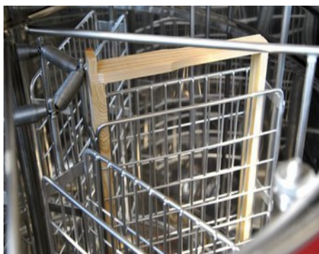
рис.1 Правильное расположение рамок в кассетной медогонке (WL, OS, D, LN, AP, )
